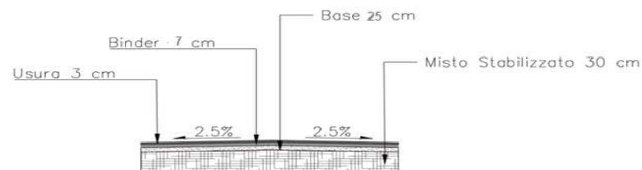
Sezione tipo della pavimentazione stradale in Progetto
