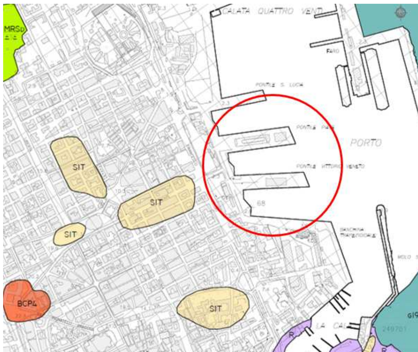
Stralcio della Carta geologica redatta nella presente fase progettuale, con indicazione dell'areale di progetto. Sigle unità geologiche: MRSd "Calcareni di Palermo", R "riporto", SIT "Sintema di Barcarello", BCP4 "Sistema di Buonfornello-Campofelice", GI9 "Sistema deposizionale della piattaforma del Golfo di Palermo"; sulla maggior parte del territorio in esame sono presenti strutture antropiche (retino).
